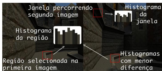
Figura 1: Funcionamento do algoritmo de correlação entre imagens
