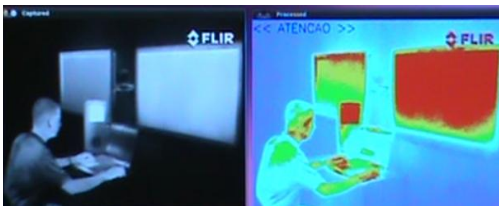
Figura 4. Detecção de Intrusos através do uso da Câmera Termal FLIR PathFindIR
