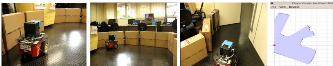
Figura 2. Tele-Operação do Robô Móvel Pioneer com o robô em São Carlos e o controle em Porto Alegre, onde a esquerda é apresentada a visão remota do sensor laser usada na navegação
